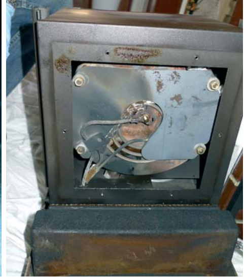
Detailansicht des gelösten Temperaturfühlers an der Unterseite des Brennertopfes; das rechte Bild zeigt die Unterseite des ausgebauten Heizeinsatzes.
