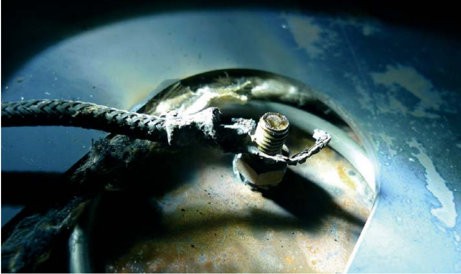
Detailansicht des gelösten Temperaturfühlers an der Unterseite des Brennertopfes; das rechte Bild zeigt die Unterseite des ausgebauten Heizeinsatzes.
