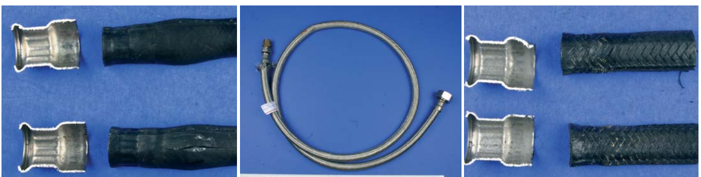
Schlauchenden und Presshülsen des flexiblen Schlauches (Mitte) werden im Labor untersucht. Rechts: die fehlerfreie Pressverbindung; die Struktur des Metallgeflechtes zeichnet sich auf dem Innenschlauch ab. Links: Bei der fehlerhaften Pressverbindung wurde das Metallgeflecht nicht mit verpresst.
